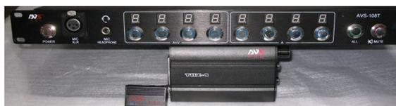
这套系统最大的特点是采用了通话 TALLY 一体化，在真正意义上满足了 EFP 演播室的通话与 TALLY 要求。AVS-108T 拥有通话及 Tally 灯号显示双功能，具备八个分站的连接端（标准配备 4 路分站），同时可与八组工作人员联系互相传递工作状况。独特的提示译码器设计使得 AVS-108 能与 SE-500 紧密配合，根据切换台的切换信息，与通话分站连接的 4 路 TD-1 提示灯（黄色接口）会用红黄两色做为摄像提示信号。红灯代表信号正在被输出或是直播，黄灯代表信号将在下一次切换中输出，就是处于备播状态，灯灭代表 FREE 状态。无论搭配任何摄像机都能和 EFP 摄像机一样拥有 TALLY 的提示功能。AVS-108 标准配备 4 路分站耳机（绿粉接口）进行与主播的通话。导播通话部分可以使用随机配置的鹅颈麦克风与导播耳机，并内置喇叭，面板上的按键可选择单独或多部分站通话。AVS-108T 标准配备 4 路 30M 通话线材，通话线材连接 AVS-108T 的一端是带锁扣的
