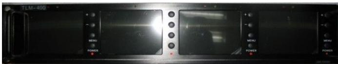
实时监看每一讯道的信号实况，以调度摄像机或者切换信号。每一台包含四个 LCD 显示画面；每个 LCD 面板可独立调整 Color(彩色)、Tint(色调)、Contrast(对比)、Brightness(亮度)；19”宽，机器高度 2U，适合系统整合搭配。
